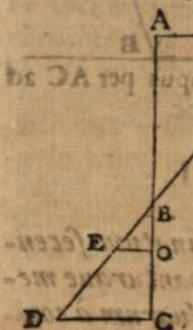
parallelia ducta sit FE. Demonstrabitur pariter tempus per AC ad tempus per reflexam CD, esse ut AC, ad CE. Nam tempus per AC ad tempus per CB est, ut AC ad CF, tempus vero per CB post AC ad tempus per CD, post eundem descensum per AC demonstratum est esse, ut CB ad CD, hoc est ut CF ad CE; ergo ex aequali tempus per AC ad tempus per CD erit, ut AC linea ad CE.
