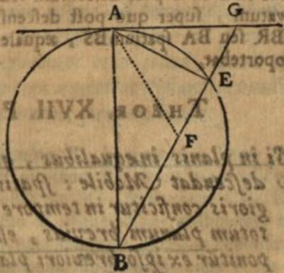
quatur quoque angulus GFA; ergo linea GF ipsi GA est æqualis. Et quia rectangulum BGE æquatur quadrato GA; erit quoque æquale quadrato GF, & tres lineæ, BG, GF, GE, proportionales. Quod si ponatur, AE esse tempus per AE, erit GE tempus per GE; & GF tempus per totam GB, & EF tempus per EB, post descensum ex G, seu ex A, per AE. Tempus igitur per AE, seu per AB, ad tempus per AEB, est, ut AE ad AEF; quod erat determinandum.
