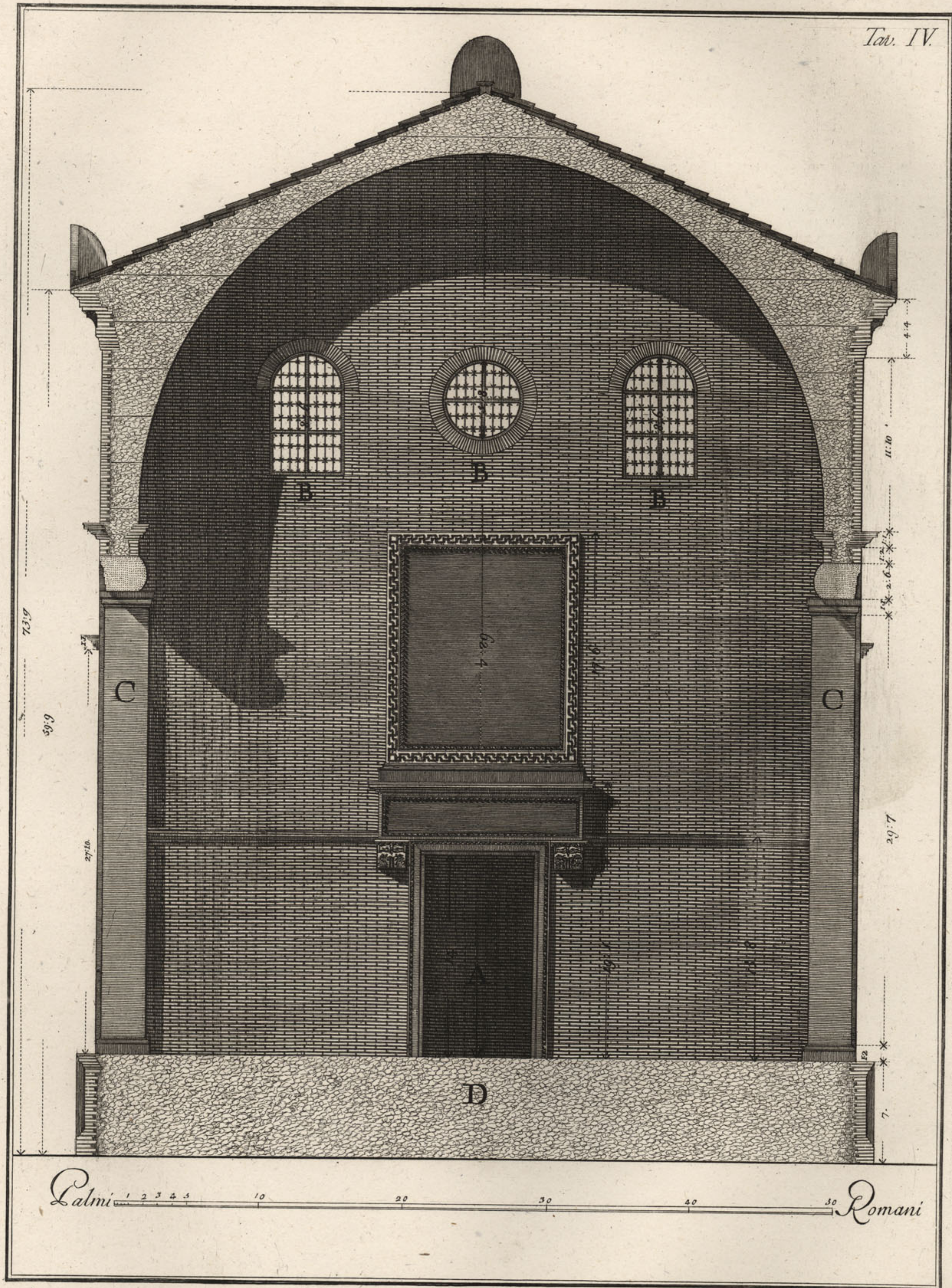
A Porta. B Fenestre, che danno lume al Tempio. C Pilastrì del Portico incontro le Colonne angolari. D Spaccato del maffo formato di tuffi dell'altezza della Scala, che ascendeva dall'Area al piano del Portico, e della Cella
