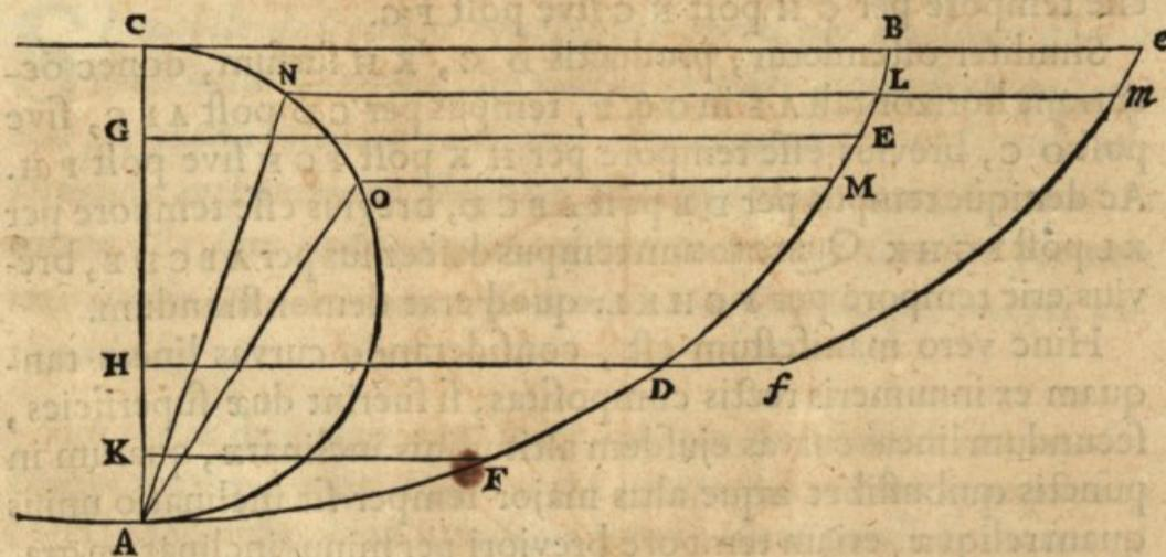
Sit Cyclois A B, cujus axis A C ad perpendicularum erectus, vertex A deorsum spectet; & accipiantur in ea portiones B D & E F, æqualis altitudinis, hoc est, ejusmodi ut parallelæ horizontales B C, D H, quæ superiorem portionem B D includunt, æque inter se
