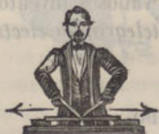
da por tres processos: por *toque singello*, correndo com uma unica barrinha magnetica (fig. 100.<sup>a</sup>) a porção de aço ou ferro que se quer magnetizar; por *toque dobrado*, correndo (fig. 101.<sup>a</sup>) com duas barrinhas o ferro, do meio d'elle para os extremos; e por *toque conjuncto*, quando, em vez de uma ou duas barrinhas, se empregam um ou dois feixes d'ellas.
