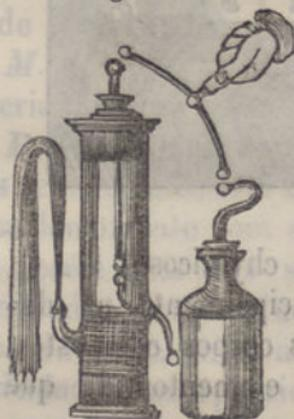
Póde-se com a descarga electrica produzir a dilatação do ar de um cano de espingarda (fig. 82.<sup>a</sup>) e disparar uma bala
