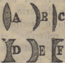
123.<sup>a</sup>) podem affectar a fórmula *biconvexa* A, *convexo-concava* B, e *plano-convexa* C. As segundas podem ser *biconcavas* D *conca-vo-convexas* E, e *plano-concavas* F.
