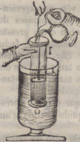
tampa *o* não cairá sustida como fica pela pressão do liquido debaixo para cima; mas se dentro do tubo em cima da tampa se deitar agua, em esta subindo a altura *b* do nivel exterior, a tampa ficará entre duas pressões iguaes, e precipitar-se-ha no fundo do vaso obedecendo ao seu proprio pêso.
