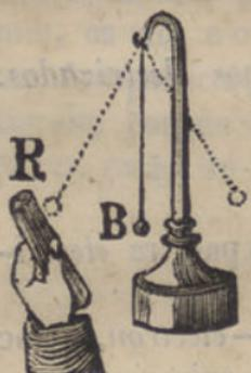
*D.* — Se, esfregando em um panno de lã ou n'uma pelle de gato um rôlo de resina *R* (fig. 76.<sup>a</sup>), o aproximarmos a uma bolinha de sabugo *B*, pendurada por um fio de seda, que é o que se chama *pendulo electrico*, a bolinha *B* mover-se-ha para o rôlo até o tocar, e depois fugirá e se afastará d'elle. O primeiro movimento é a *attracção electrica*, o segundo a *repulsão electrica*. As *faiscas* e os *estalidos* percebem-se optimamente na machina electrica.
