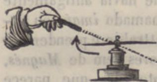
*D.* — Chegando-o a uma pouca de limalha de ferro (fig. 95.<sup>a</sup>), ou a uma agulha (fig. 96.<sup>a</sup>) sustida sobre um fulcro, qualquer d'estes dois objectos mover-se-ha para o corpo ensaiado, se for magnete.
