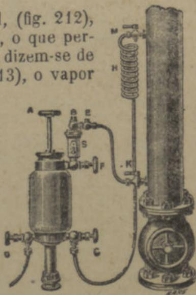
Fig. 213 — Copo lubrificador por condensação exterior
