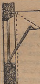
Fig. 6 — DISPOSIÇÃO DE JANELLA PARA CAVALLARIÇA
