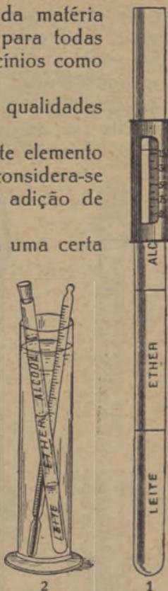
Fig. 5 — 1. Lacto-butímetro Marchand; 2. Dosagem da gordura com o lacto-butímetro
