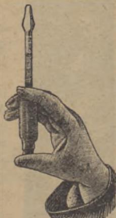
Fig. 11 — Modo de fazer a leitura do butirómetro
