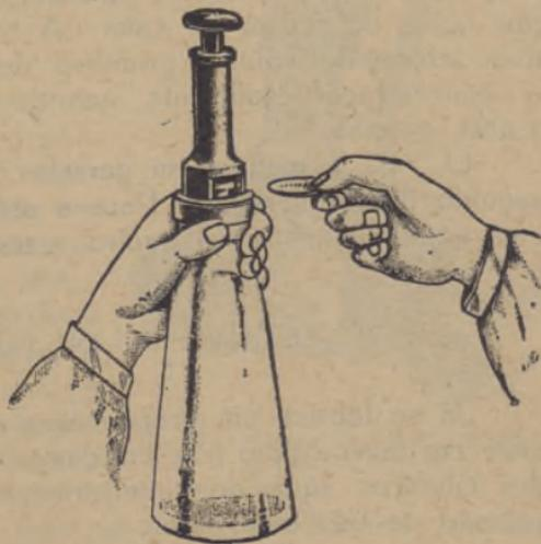
Fig. 34— Máquina para meter as rodelas de cortiça nos frascos.
