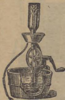
Fig. 26 — Máquina para lavagem de frascos
