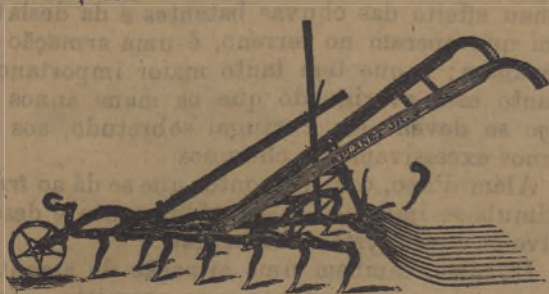
Fig. 31 — Grade Planet de cavallo, para trabalho das entrelinhas
