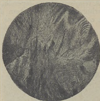
Fig. 38 — Micrographia d'um aço com 1 % de carbono. Augmento 220 diametros
