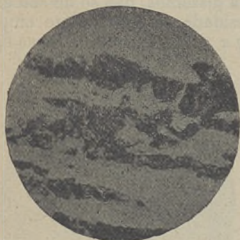
Fig. 37—Micrographia d'um aço com 0,37 % de carbono. Augmento 150 diametros
