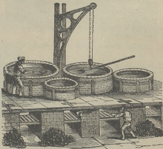
Fig. 59 — Appareho Pattinson para afinação de chumbo argenteiro
