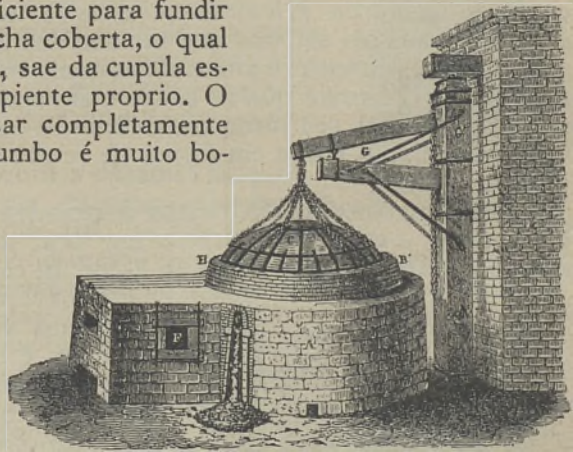
Fig. 66 — Vista do forno allemão para cupellação da prata
