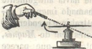
*D.* — Chegando-o a uma pouca de limalha de ferro (fig. 95.<sup>a</sup>), ou a uma agulha (fig. 96.<sup>a</sup>) sustida sobre um fulcro, qualquer d'estes dois objectos mover-se-ha para o corpo ensaiado, se fôr magnete.
