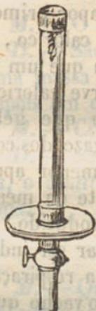
2.<sup>a</sup> Experiencia. — Prova-se igualmente que o fumo, que vemos subir e dissipar na atmosphaera, cae no vacuo, como qualquer outro corpo. Póde para isto servir o tubo precedente fazendo-lhe entrar o fumo pela extremidade superior.
