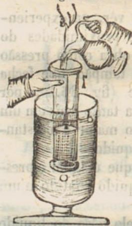
tampa *o* não cairá sustida como fica pela pressão do liquido debaixo para cima; mas se dentro do tubo em cima da tampa se deitar agua, em esta subindo a altura *b* do nivel exterior, a tampa ficará entre duas pressões iguaes, e precipitar-se ha no fundo do vaso obedecendo ao seu proprio pêsso.
