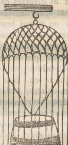
lão vazio; a fig. 50.<sup>a</sup> um balão quando se está a encher de gaz, de hydrogenio, por exemplo, cuja densidade é menor que a do ar (vid. Taboas de densidade). — — Como se vê, o principio de Archimedes é tão exacto para os liquidos como para os gazes: um corpo qualquer elevar-se-ha ao ar quando fôr menos denso que elle, e por uma força de impulsão igual á differença do peso do corpo e do de um igual volume de ar; exactamente como uma rolha de cortiça vem do fun-
