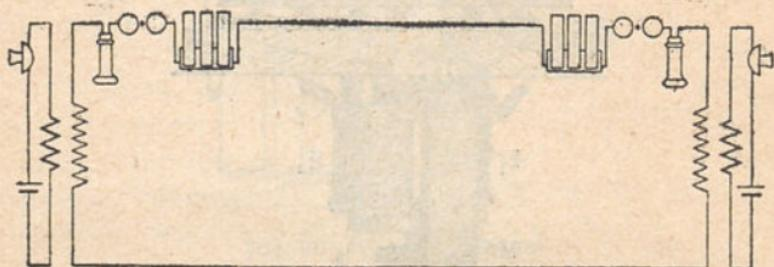
Fig. 109 — Circuito em série com volta metálica
