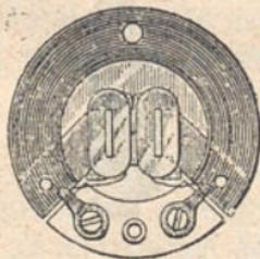
Fig. 91 — Magnete do receptor de caixa de relógio
