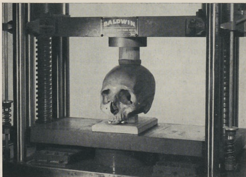
Fig. 3 — Crânio a ser submetido a compressão numa prensa electrónica «Baldwin».
