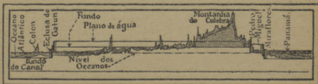
Fig. 47. — Perfil longitudinal do canal do Panamá.
