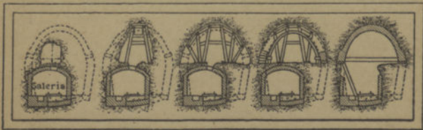
Fig. 95. — Um dos processos de construção do segundo subterrâneo do Simplon.
