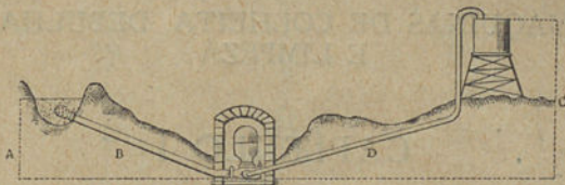
Fig. 53 — Esquema da instalação de um carneiro hidráulico
