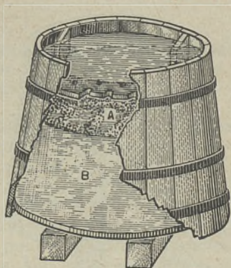
Curtimenta com chapéu submerso. A, chapéu ou manta; B, mosto
