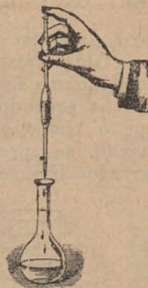
Fig. 4 — ...coloca-se o bico da chupeta sobre o recipiente e, levantando o dedo, deixa-se escorrer o líquido até ao traço inferior...
