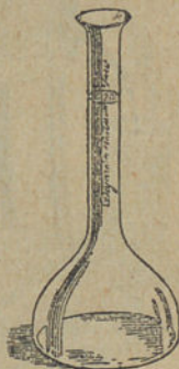
Fig. 18 — Garrafa própria para medir a quantidade de vinho a destilar. Ver o traço circular na parte superior do gargalo
