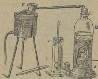
Fig. 21 — Pequeno alambique, para doseamento do alcool nos vinhos — (Salleron)
