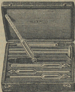
Fig. 25 — Jôgo de alcoómetro em estojo, com proveta e termómetro
