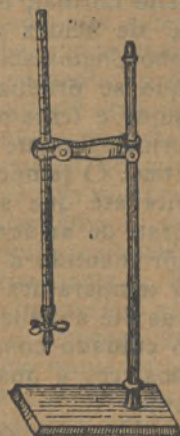
FIG. 6 — Supporte com uma galheta, ou bureta
