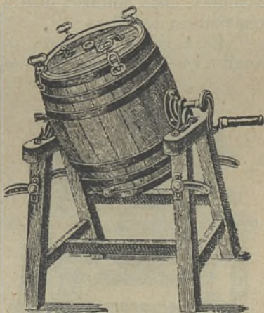
Fig. 14 — Bateadeira manual, modificação da bateadeira normanda, modelo Progrés, de emprêgo freqüente
