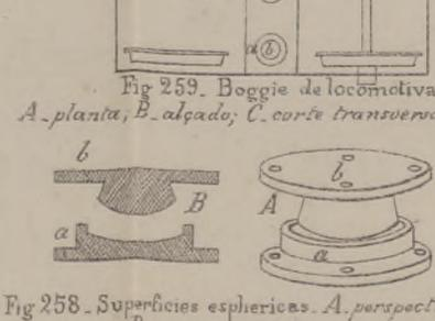
Fig 258. Superfícies esfericas. A - perspectiva; B - corte vertical
