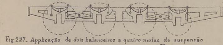
Fig 237. Applicação de dois balanceros a quatro molas de suspensão
