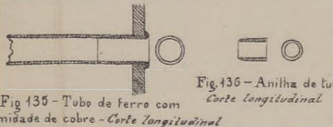
Fig. 135 - Tubo de ferro com a extremidade de cobre - Corte longitudinal
