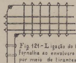
Fig. 121 - Ligação do tecto da fornalha ao envoltorio exterior por meio de tirantes
