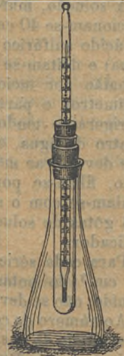
Fig. 7.—Aparêlho para determinar o ponto de solidificação dos ácidos górdos.
