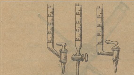
Fig. 10. — Extremidade inferior de buretas com torneira de vidro
