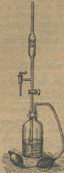
Fig. 5. — Pipeta para medir em exactidão 20 cm. 3 do reagente usado no método de Hüml.
