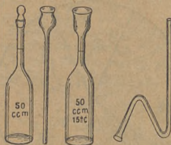
Fig. 4. — Picnómetro ou frasco de densidades de REISCHAUER, com marca no colo (dois modelos), e sifão para o esvasiar.
