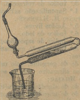
Fig. 2. — Enchimento de picnómetro de SPRENGEL
