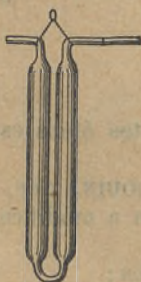
Fig. 1. — Picnómetro de SPRENGEL: Capacidade 10 a 20 cm. 3 ; tubo de entrada 0,5 mm., e o de saída de 1 mm.
