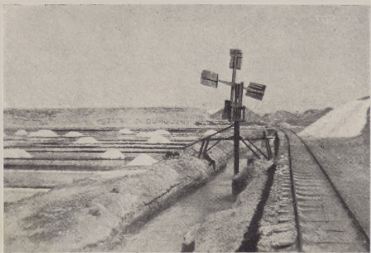
FIG. 64 — C. a do Fomento de Cabo Verde, Ilha do Sal, Santa Maria Bomba alimentando as salinas
