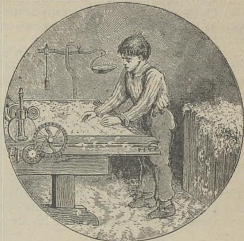
Fig. 34 — Alimentação manual de lã na carda
