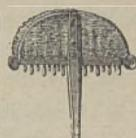
Fig. 80—Antiga operação do levantamento do pêlo
