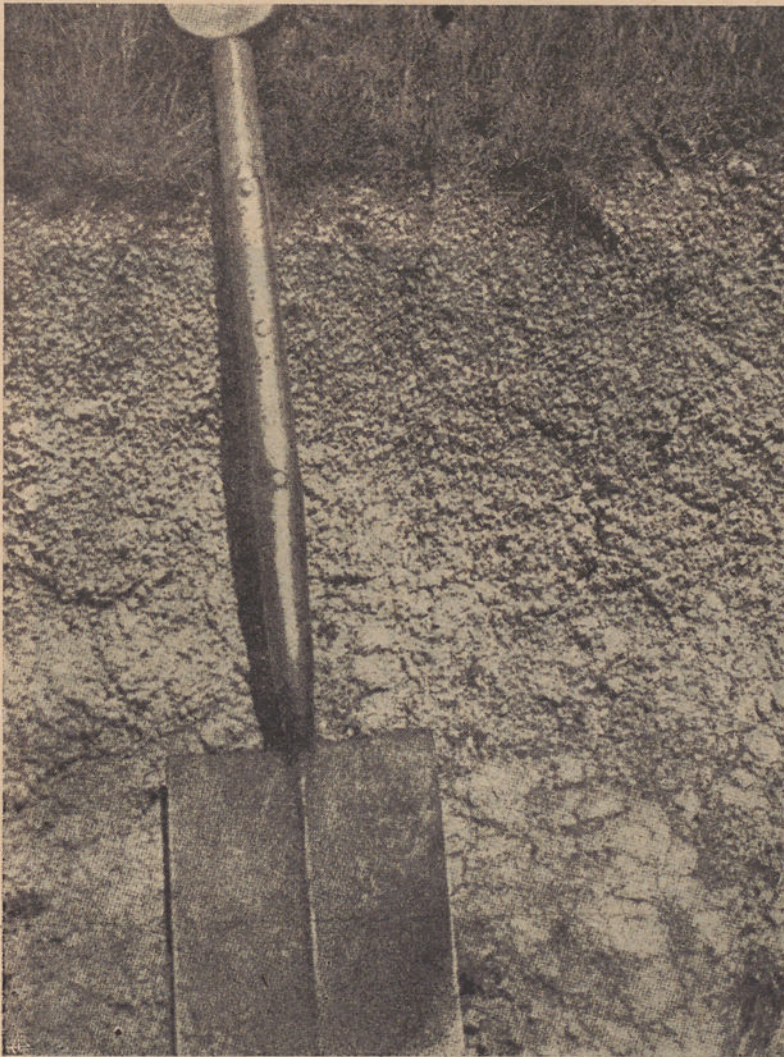
Fig. 1 — O solo deve ser estudado em toda a sua espessura, como indica a figura, e não somente pelas amostras colhidas ao acaso na camada superficial.
