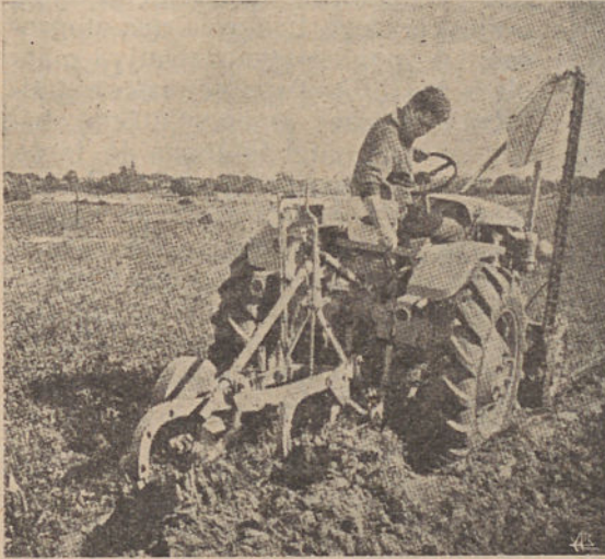
Tractor Renault « Diesel » de 16 cv, equipado com uma charrua de 2 ferros e gadanheira.
