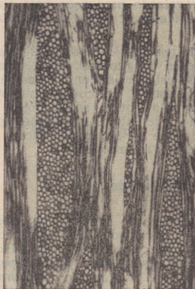
Microfotografia do plano tangencial do lenho do Plátano
