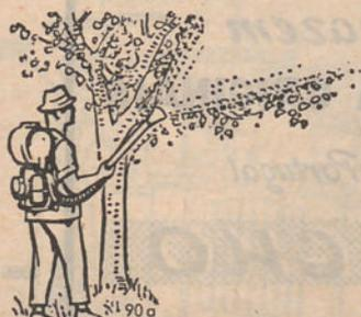
Podem ser montados com bocal duplo para duas saídas, e bomba de elevação com tubo de prolongamento para tratamento de árvores e ramadas altas
